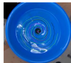
図5 初速約 0.20m/s のときの渦の軌道
