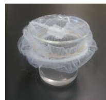
【図2】ポリマーから溶液を除いている様子
