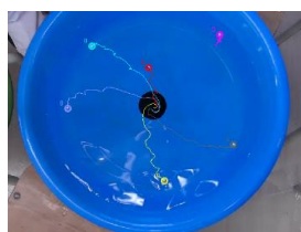
図3 水を静止させたときの水流の軌道
